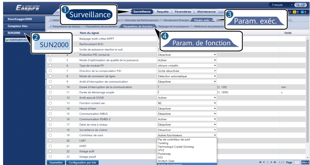
Figure 6-48 Configuration du contrôleur du système de suivi
