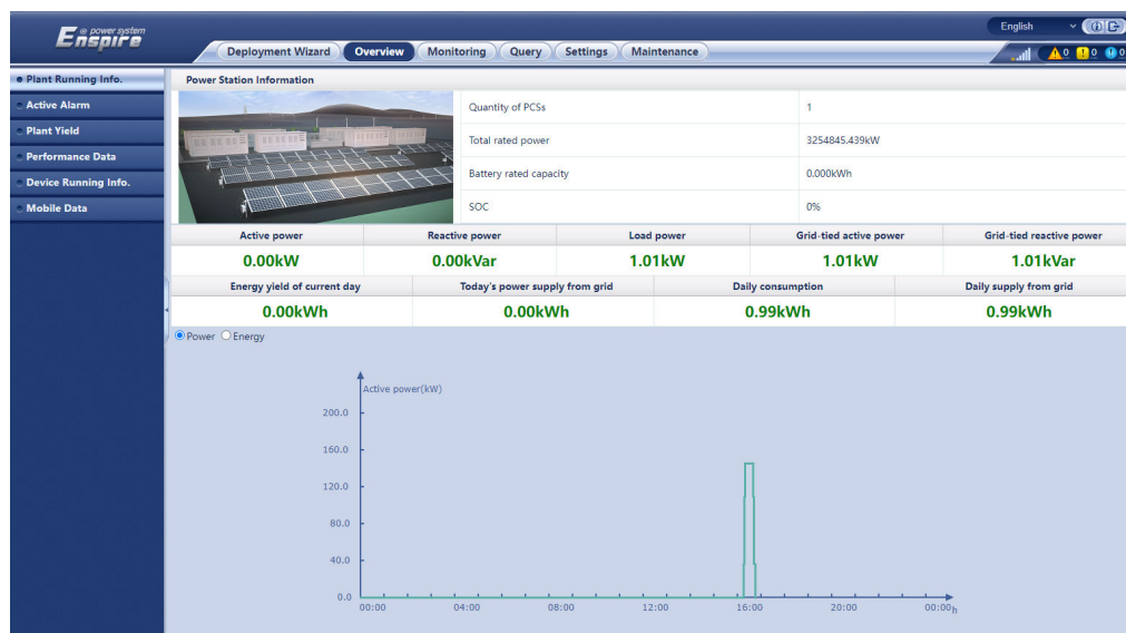
Figure 6-5 Informations sur le fonctionnement de la centrale (avec compteur électrique et batterie)
